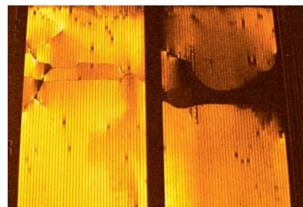
破裂的CIS组件
